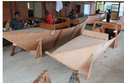
(d) All four deck panels cut to size
