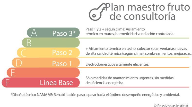
Figura 7. Rehabilitación paso a paso hacia el óptimo desempeño energético y ambiental. Resumen general de ejemplos calculados para el diseño técnico de la NAMA de Vivienda Existente. Fuente: Passivhaus Institut.
